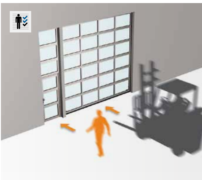
Türen und Tore für Menschen und Güter getrennt, aber in der gleichen lichten Öffnung.
