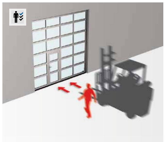
Schlupftür für Menschen, integriert in das Sektionaltor für Güter.
