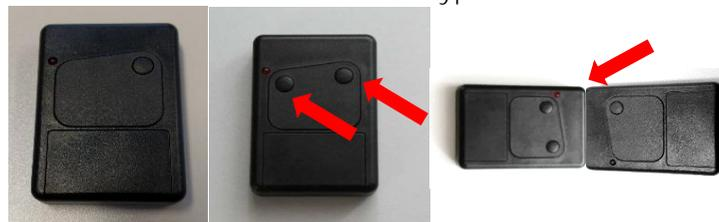
Zuerst bei bereits funktionierendem Handsender Taste drücken: bei 2-Kanal beide Tasten gleichzeitig drücken, bei 1-Kanal nur 1 Taste drücken. Lampe muss blinken; dann beim anzulernenden Sender gewünschte Taste drücken.
