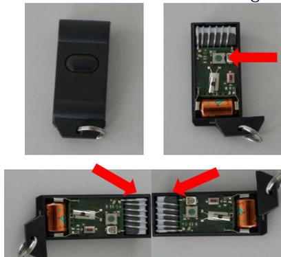
Zuerst rote Taste bei anzulernenden Sender drücken dann gleichzeitig, bei bereits funktionierendem Taster und bei anzulernendem auf grüne Taste drücken.
