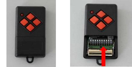
1. Die vorhandenen 10 Dip-Schalter mit der ON-OFF-Stellung zwischen Empfänger und Handsender identisch einstellen
