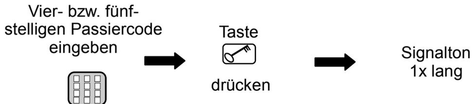
**Ein korrekter Code wird erkannt; das entsprechende Relais zieht an!**
