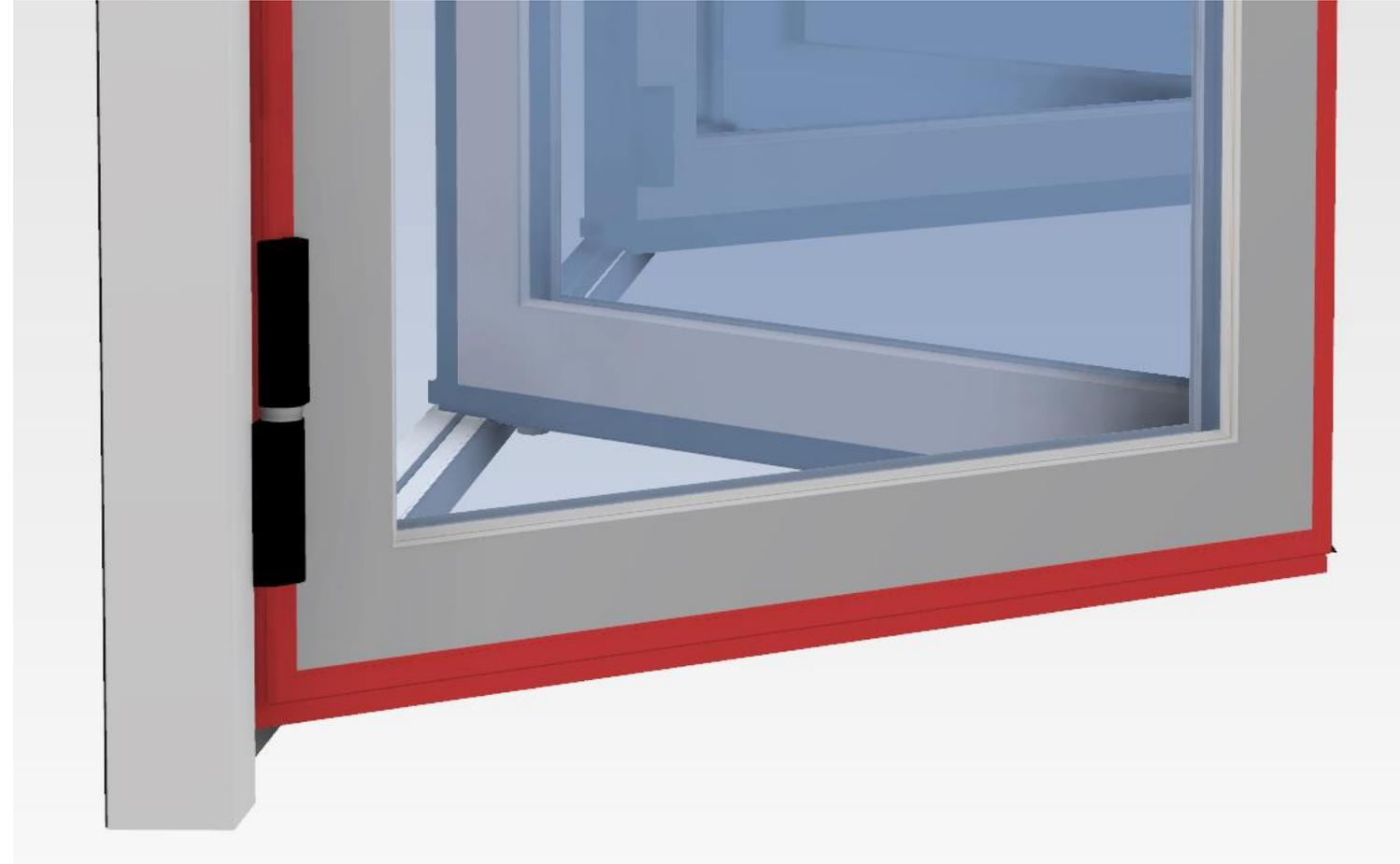
Vergleich zum Falttor AL603F: Konturen der Dichtungen sind nicht aufeinander abgestimmt
