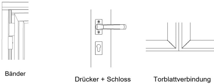
Die Bauteile sind auf Anzeichen von Verschleiß, Beschädigung, Deformation und Halt zu überprüfen.
