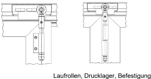
Die Bauteile sind auf Anzeichen von Beschädigung, Deformation und sicheren Halt zu überprüfen.
