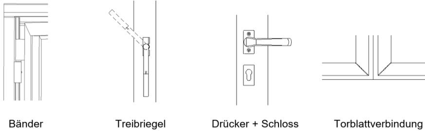
Die Bauteile sind auf Anzeichen von Verschleiß, Beschädigung, Deformation und Halt zu überprüfen.
