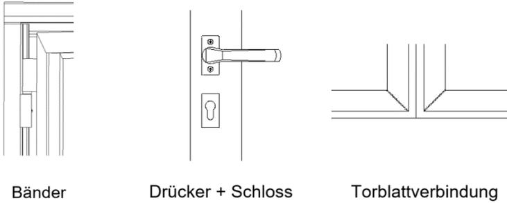
Die Bauteile sind auf Anzeichen von Verschleiß, Beschädigung, Deformation und Halt zu überprüfen.
